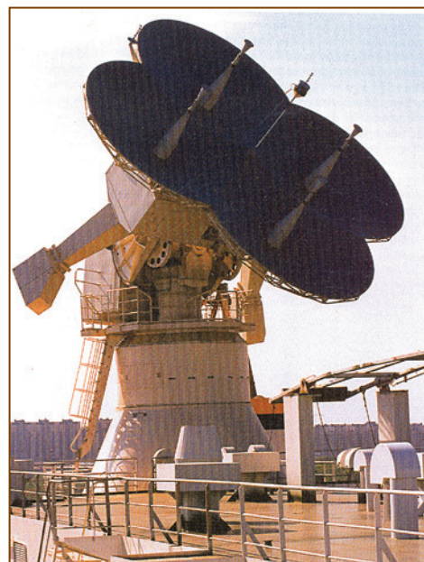
CM-391A — слегающая машина, крупная антенна для связи с космосом, сделана ижорцами, установлена на командном судне проекта «Морской старт».
